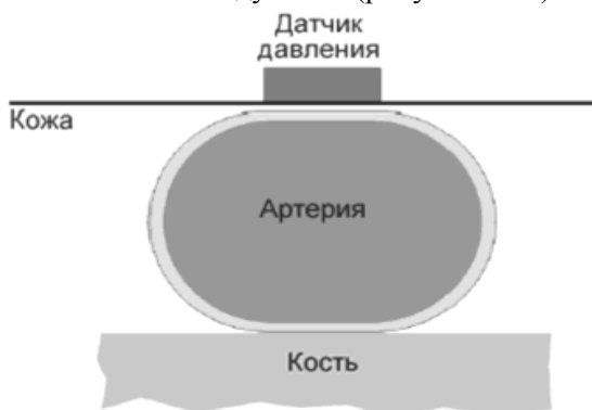
Рисунок 2.12 – Регистрация сигнала артериальной пульсации крови с помощью метода аппланационной сфигмографии
